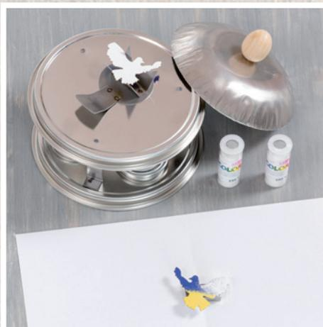
**3** Wenn beide Farbschichten fertig sind, kann optional eine weiÙe Schicht auf der Rückseite aufgetragen werden. Dazu das Pulver wie in Step 2 auftragen. **ACHTUNG:** Zum Brennen auf einen Gegenemailständer platzieren, um Ankleben zu vermeiden. Diese Technik verwenden, um eine Schicht transparentes Efcolor über der Farbseite aufzutragen.
